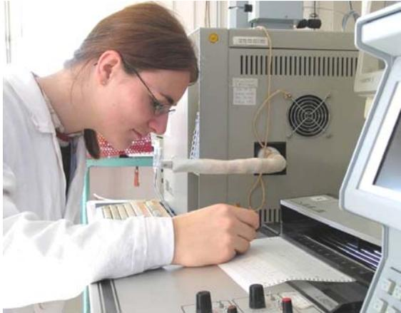
1. Abriechen des Gaseffluenten einer gaschromatographisch aufgetrennten Probe und Markieren geruchsaktiver Stellen im Chromatogramm
