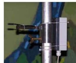
CO<sub>2</sub>-Sensor und kombinierter Temperatur- und Feuchtesensor
