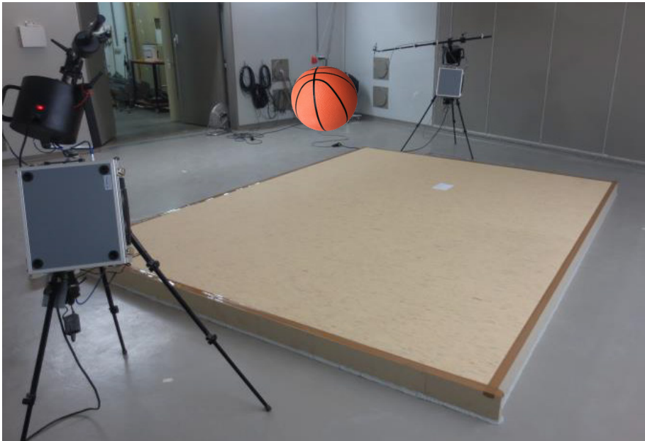
Hallraum - zusätzliche Messung der Schallabsorption
