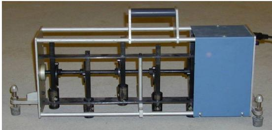
Messung der Trittschall-dämmung
