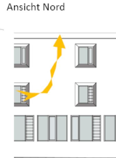
Alle Lüftungsöffnungen sind einbruch- und mit Wetterschutzgitter regensicher (kein Regenwächter erforderlich). Die Nachtlüftung kann zur sommerlichen Verbesserung des Raumklimas beitragen. Allerdings werden die Effekte gering sein, weil die thermische Gebäudemasse gering ist. Zu Forschungszwecken soll in einem Klassenzimmer mit PCM die thermisch aktive Gebäudemasse vergrößert werden.
